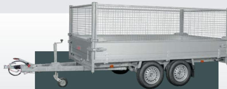
Mit den Gitteraufsätzen schaffen Sie zusätzliches Ladevolumen. Diese 70 cm hohen Laubgitteraufsätze werden auf die serienmäßigen Seitenwände gesteckt (siehe Tabelle).
