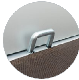
8 Bindehaken an der Innenseite der Ladefläche
